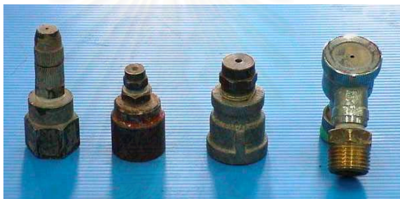
รูปที่ 6.9 แสดงลักษณะของหัวฉีดที่ใช้ในโรงโม่หิน
