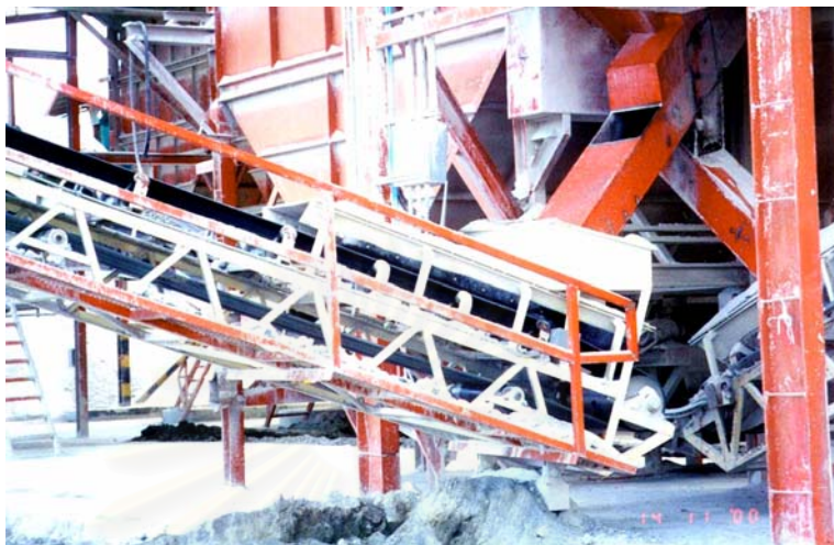
รูปที่ 6.5 ภาพถ่ายแสดงสภาพพื้นที่ของโรงโม่หิน 1 บริเวณสายพาน ๓ ตำแหน่งทางออกจากตะแกรงคัดหินชั้นสุดท้าย เพื่อลำเลียงหินไปยังกองหินเบอร์
