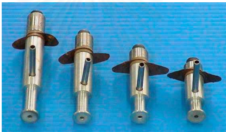
รูปที่ 5.16 ภาพถ่ายแสดงลักษณะของหัวฉีดคลื่นเหนือเสียงชนิดที่ใช้เพียโซอิเล็กทริกเซรามิกเป็นตัวกำเนิดคลื่นเหนือเสียงที่ใช้ในการทดลอง
