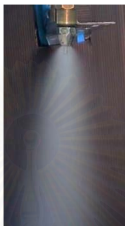
รูปที่ 7.24 ภาพถ่ายแสดงรูปแบบของการสเปรย์ที่ได้จากหัวฉีดชนิดที่ใช้เรโซเนเตอร์เป็นตัวกำเนิดคลื่นเหนือเสียง
