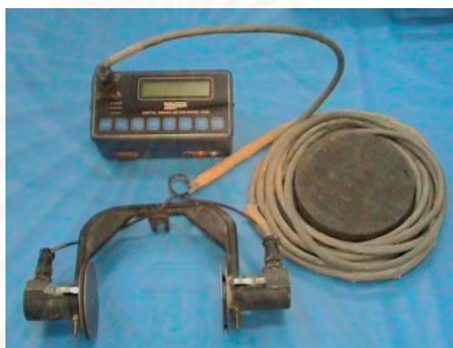
รูปที่ 6.4 ภาพถ่ายของเครื่อง Smoke Opacity Meter
