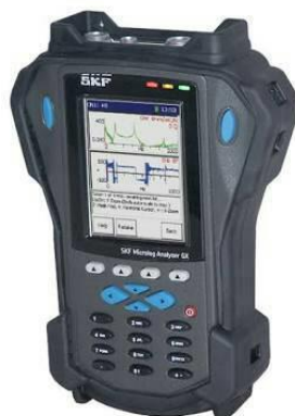
รูปที่ 3.5 เครื่องมือสำหรับวัดค่าความสั่นสะเทือน
