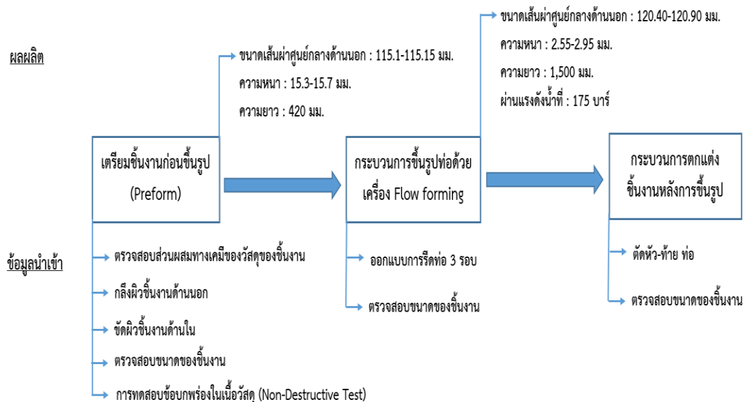
รูปที่ 1 กระบวนการผลิตท่อแรงดันสูง
