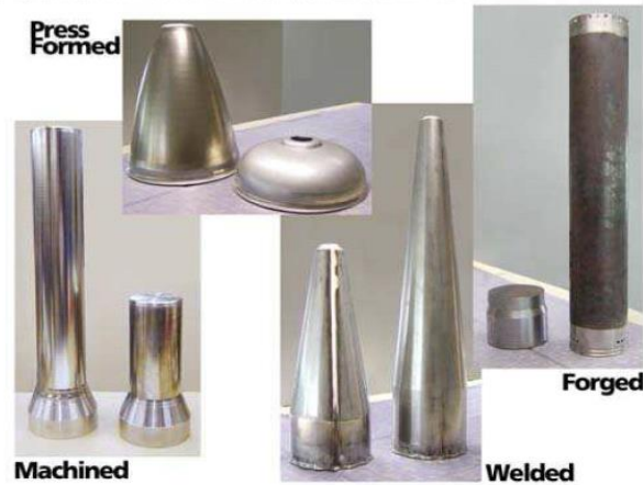
รูปที่ 13 การเตรียมชิ้นงาน (Pre-form) แบบต่างๆ
