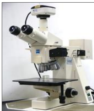
รูปที่ 24 กล้องจุลทรรศน์แบบแสงแบบแสงสะท้อน (Reflected Light Microscope) รุ่น ZEISS Model Axiotech
