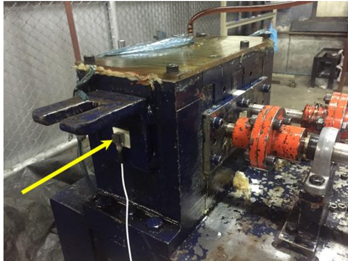
รูปที่ 5.13 ภาพถ่ายตำแหน่งการติดตั้งเซ็นเซอร์วัดความเร่งในแนวระดับซึ่งตั้งฉากกับแกนหมุน
