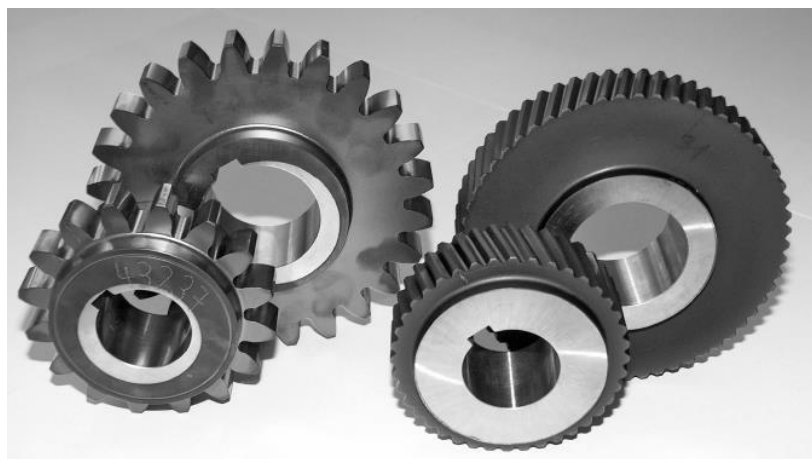
รูปที่ 1.2 เฟืองตรงอ้างอิงและเฟืองเฉียงที่มีกำลังสูญเสียน้อยในงานวิจัยของ Bernd-Robert Höhn [2]
