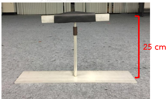
รูปที่ 3.5 ที่รองคางสำหรับการใช้งานทัชสกรีน
