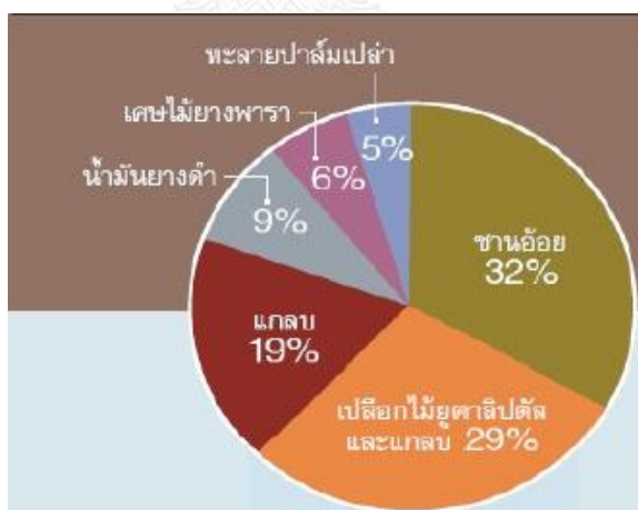
รูปที่ 2.9 สัดส่วนการนำกากเหลือใช้ทางการเกษตรมาใช้เป็นเชื้อเพลิงชีวมวลในโรงไฟฟ้าขนาดใหญ่ (กรมพัฒนาพลังงานทดแทนและอนุรักษ์พลังงาน, 2557a)
