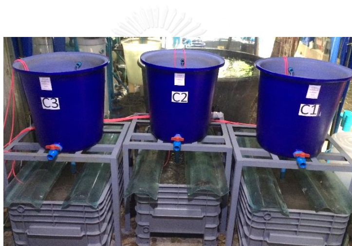
รูปที่ 3.14 การติดตั้งอุปกรณ์แสดงการหมุนเวียนน้ำและตะกอนชีวภาพของชุดควบคุมในการทดลองครั้งที่ 3
