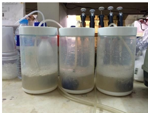
รูปที่ 3.6 การติดตั้งอุปกรณ์เพื่อวิเคราะห์อัตราการบำบัดแอมโมเนียของตะกอนไบโอฟล็อก
