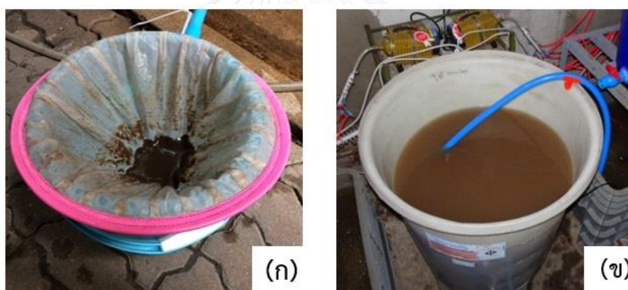
รูปที่ 4.25 การถ่ายตะกอนส่วนเกินออกจากระบบด้วยวิธีการกรองผ่านกระชอนที่มีช่องกรองขนาดเล็กสำหรับชุดทดลอง (ก) และวิธีการตกตะกอนสำหรับชุดควบคุม (ข)
