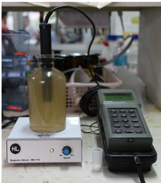
รูปที่ 3.7 การติดตั้งอุปกรณ์เพื่อวิเคราะห์อัตราการใช้ออกซิเจนของตะกอนไปโอฟล็อก
