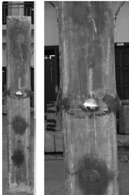
รูป 2.14 รูปแบบการวิบัติของตัวอย่าง L4L10-6 (Wang และคณะ 2010)
