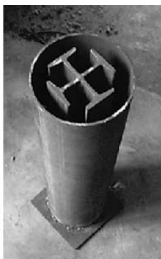
รูป 2.1 การเชื่อมต่อตัวอย่างทดสอบของ Wang และคณะ (2004)
