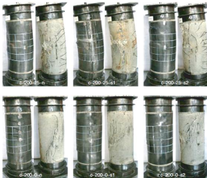
รูป 2.19 รูปแบบการวิบัติของเสาตัวอย่างจากการทดสอบ
