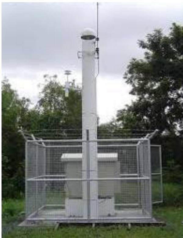
รูปที่ 3.2 ภาพตัวอย่างสถานีรับสัญญาณดาวเทียมของกรมโยธาธิการและผังเมือง
