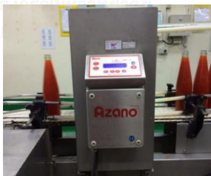
รูปที่ 3.6 การตรวจจับโลหะโดยเครื่อง Metal detector
