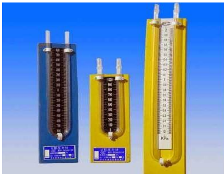
รูปที่ 5.6 อุปกรณ์วัดความดันแบบมานอมิเตอร์ ( https://www.aliexpress.com )
