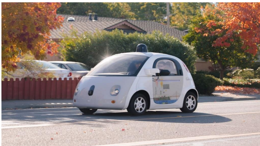
ภาพแสดงตัวอย่างรถยนต์ที่ใช้เทคโนโลยีระดับที่ 4 29
