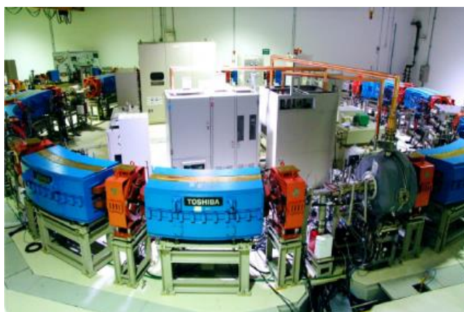
รูปที่ 2.10 เครื่องเร่งอนุภาคแนววงกลม (Booster synchrotron) ที่มา: สถาบันวิจัยแสงซินโครตรอน (2559)
