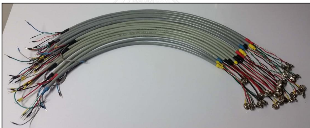
รูปที่ 4.5 สายซิลด์ชนิด 3 แกนและ 4 แกนที่ใช้ในการวัดสัญญาณ ECG 49 ลีด
