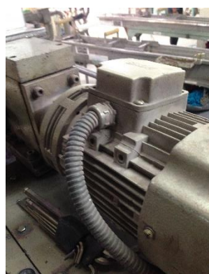
รูปที่ ค.6 วิธีการปฏิบัติงานการตรวจสอบสายไฟของฮีตเตอร์ เทอร์มอคัทเปิด และสายวัดความเร็วรอบมอเตอร์
