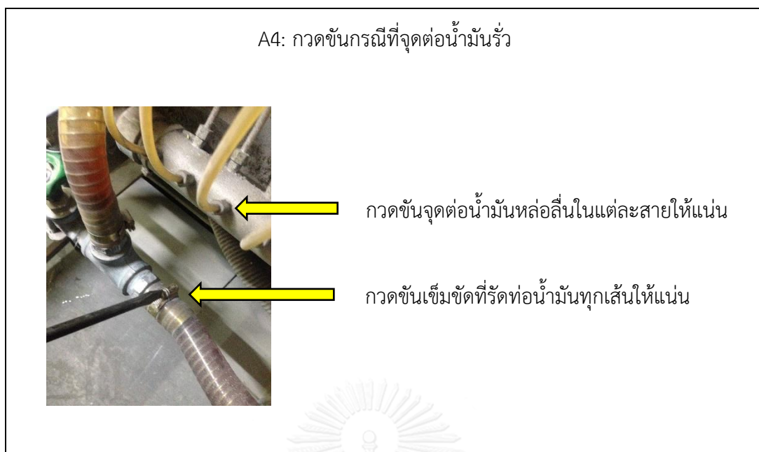
รูปที่ 5.20 วิธีการปฏิบัติงานการกวดขันกรณีจุดต่อน้ำมันรั่ว
