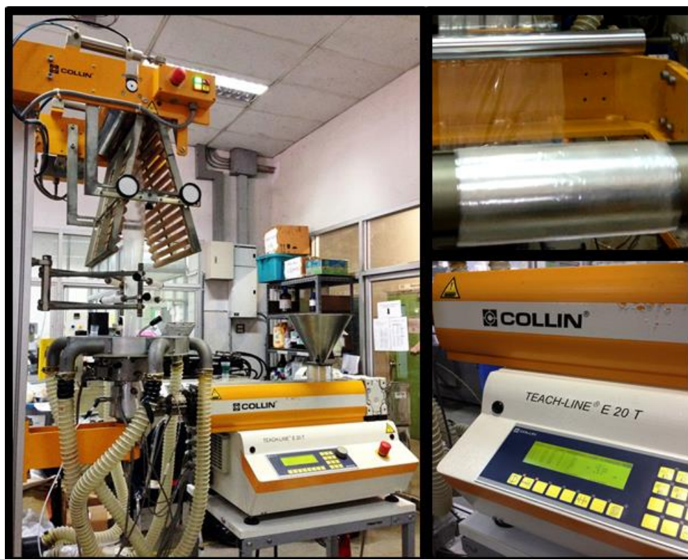
ภาพที่ 3.4 เครื่องขึ้นรูปฟิล์มด้วยวิธีการเป่า รุ่น Blown film BL 180/400E
