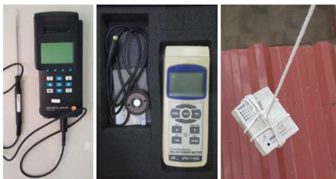
ภาพที่ 27 อุปกรณ์วัดความเร็วลม (ซ้าย) อุปกรณ์วัดรังสีอาทิตย์ (กลาง) อุปกรณ์วัดค่าความอุณหภูมิและความชื้น (ขวา) ตามลำดับ
