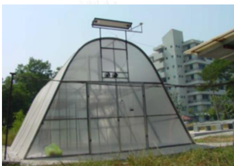
ภาพที่ 18 เรือนกระจกจำลองที่ติดตั้งพัดลมระบายอากาศพลังงานแสงอาทิตย์เพื่ออบแห้งกล้วย (Janjai, Chaichoet and Intawee, 2005)
