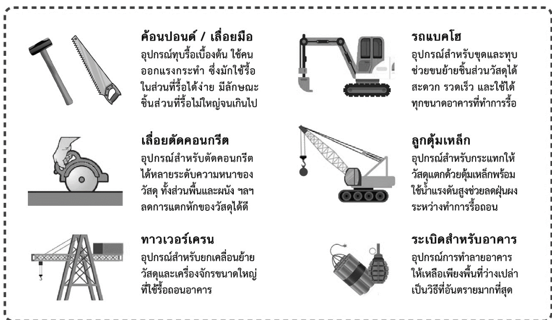
รูปที่ 2.21 เครื่องมือที่ใช้ในการรื้อถอน
