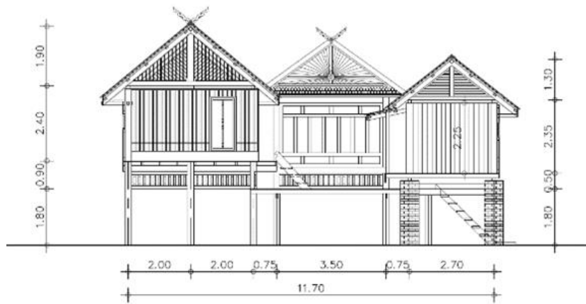
ภาพที่ 5.10 แสดงรูปตัดของเรือนสิงห์แก้ว
