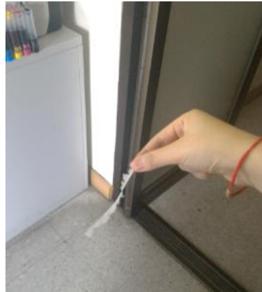
ภาพที่ 3.14 การเก็บข้อมูลทิศทางการลมด้วยกระดาษทิชชู
