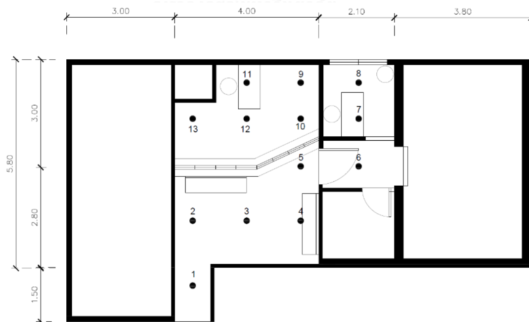
ภาพที่ 3.15 ตำแหน่งการวัดความเร็วลมภายในคลินิกวินโรคแห่งหนึ่ง
