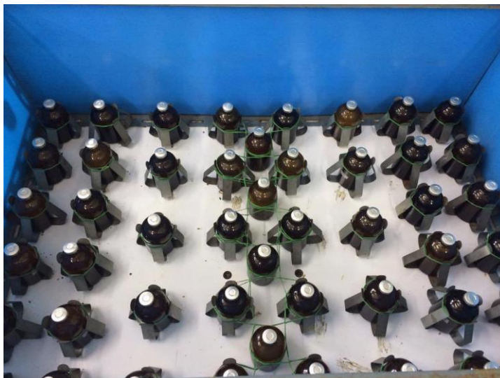
ภาพที่ 3-5 ชุดการทดลองบีเอ็มพีในการศึกษาปริมาณก๊าซชีวภาพ
