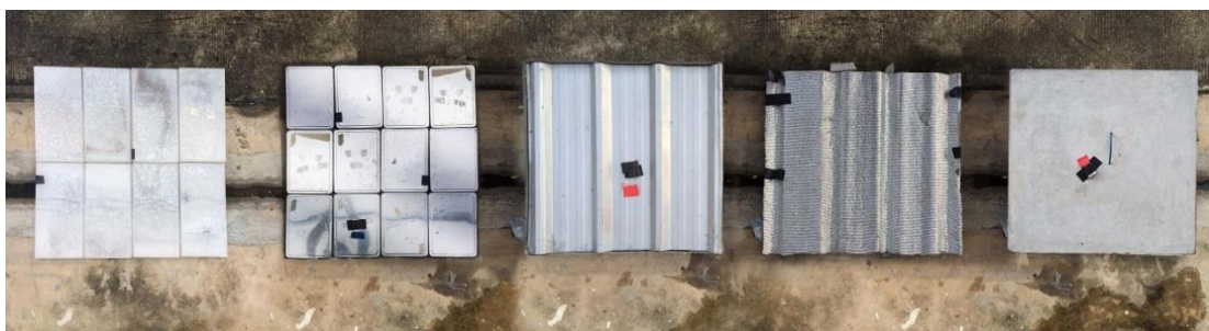
ภาพที่ 3.9 ตัวแปรการทดลองที่ 2; 1.กล่องพลาสติกโพลีสไตรีน (PS); 2.กล่องสแตนเลส (SL); 3.กล่องเมทัลชีท (MS); 4.เมทัลชีทกรูพอยล์ด้านล้าง (MF); 5.แผ่นคอนกรีต หนา 5 ซม (CC) (ซ้าย-ขวา)
