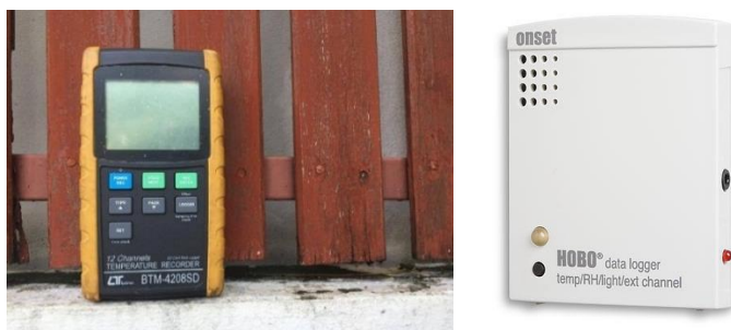
ภาพที่ 3.1 เครื่องมือวัดอุณหภูมิ 12 Channels Temperature Recorder (ซ้าย) และ HOBO Temp/RH/2 External Channel Data Logger U12-013 (ขวา)
