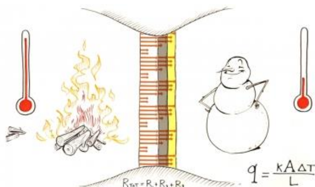
ภาพที่ 2.9 การต้านทานความร้อนของวัสดุทั่วไป
