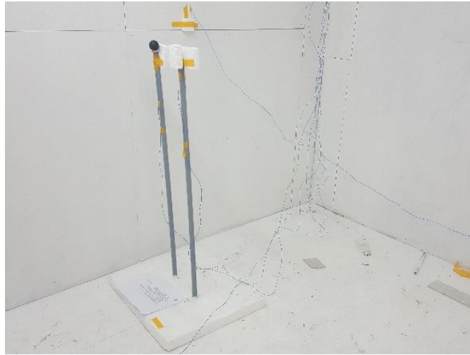
ภาพที่ 21 การติดตั้งสายวัดอุณหภูมิห้อง
