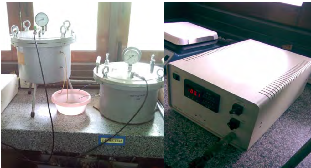
รูปที่ 2.8 แสดงเครื่อง Pressure chamber และหน้าปัดที่ใช้ปรับความดันของเครื่อง
