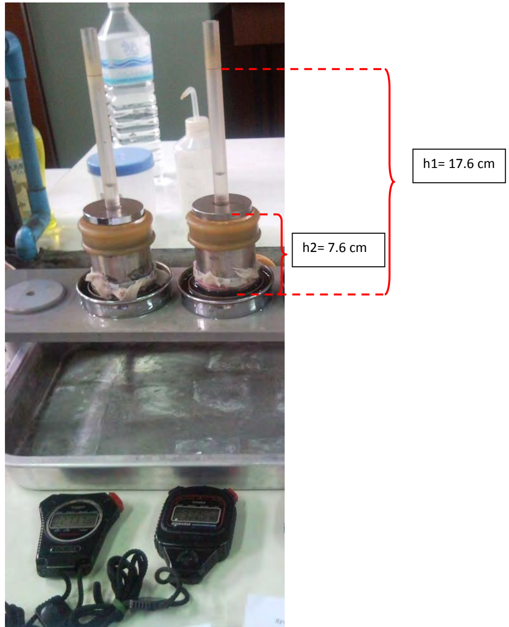
รูปที่ 2.6 แสดงอุปกรณ์และลักษณะการทำกรทดลองหาค่าสัมประสิทธิ์การซึมผ่าน
