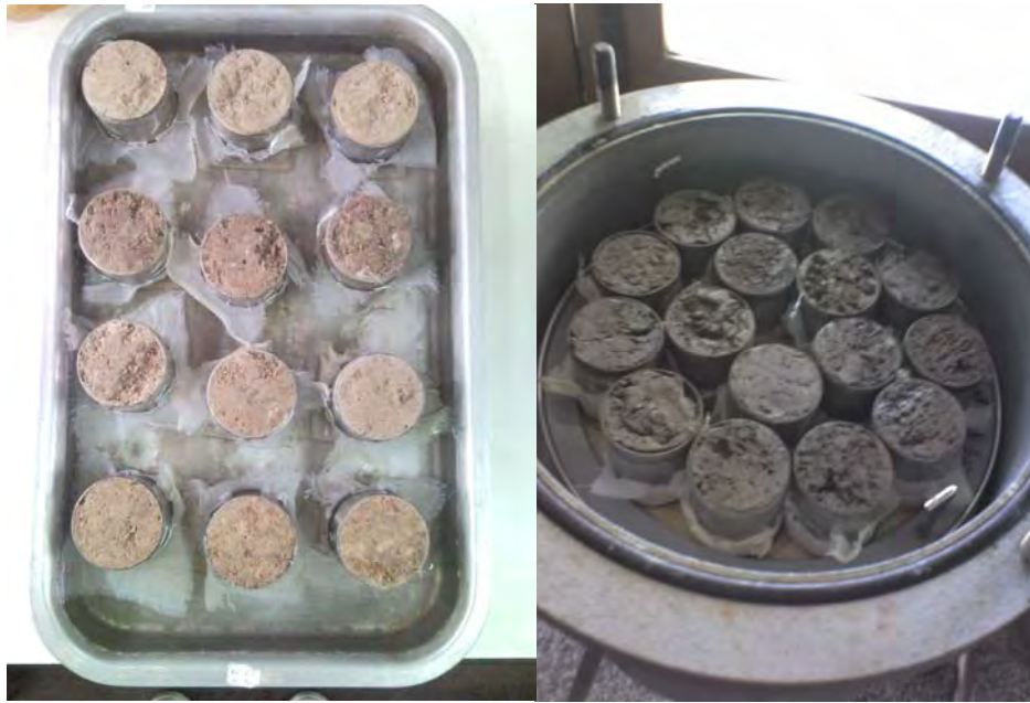
รูปที่ 2.7 แสดงตัวอย่างแท่งดินที่แช่น้ำเพื่อให้ดินอิ่มตัวด้วย และลักษณะการบรรจุตัวอย่างลงใน Pressure chamber
