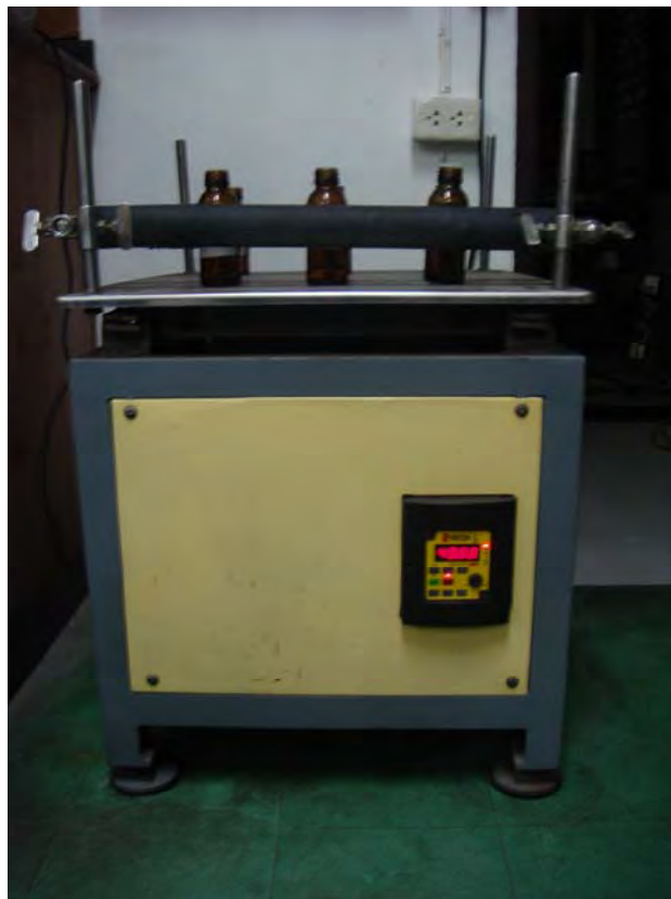
รูปที่ 2.10 เครื่องเขย่า และลักษณะการวางตัวอย่างในเครื่องเขย่า
