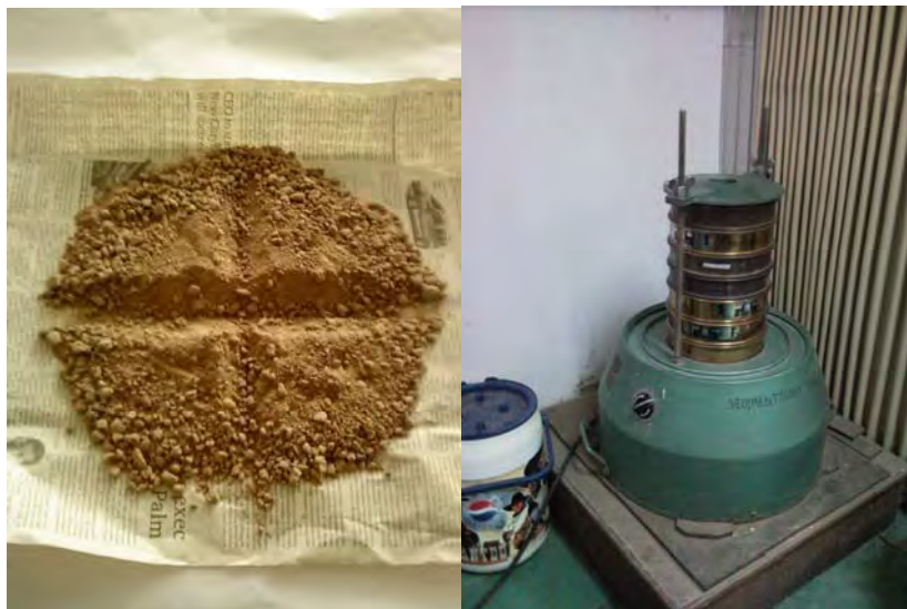
รูปที่ 2.5 วิธีการสุ่มตัวอย่างเพื่อหาประเภทเนื้อดินโดยวิธี sieve analysis และเครื่อง Sieve Shaker
