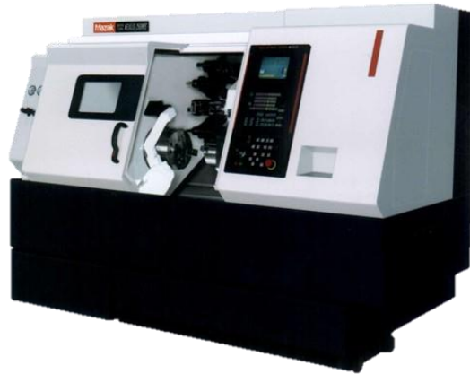
รูปที่ 2.3 เครื่องกลึง CNC (CNC Turning Machine)
