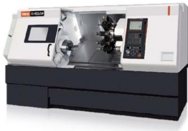
รูปที่ 3.8 เครื่องกลึงซีเอ็นซี ชนิด 4 แกน
