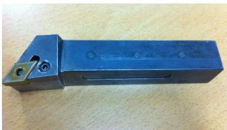
รูปที่ 3.6 ด้ามมีด (มุมคายเศษโลหะเป็นลบ)
