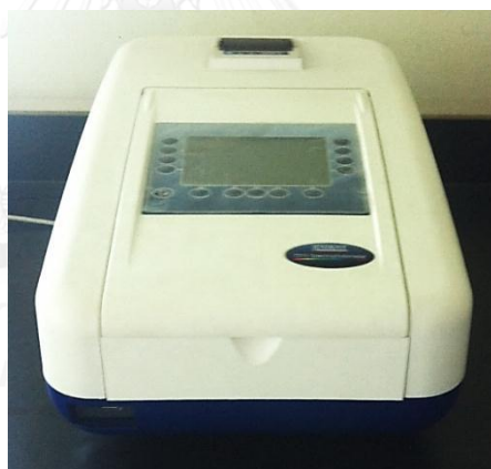
รูปที่ 3.13 เครื่องยูวี-วิสิเบิลสเปกโทรโฟโตมิเตอร์ ยี่ห้อ Jenway รุ่น 7315
