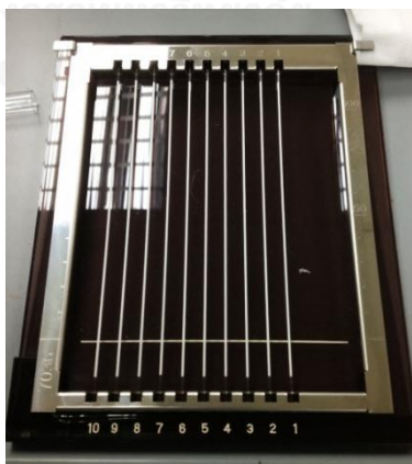
รูปที่ 3.6 แท่งควอตซ์สำหรับจุดสารละลายตัวอย่าง
