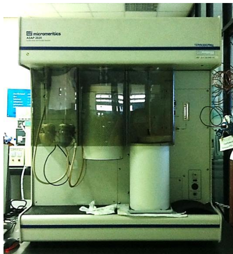
รูปที่ 3.18 เครื่อง Surface area and porosity analyzer ยี่ห้อ Micromeritics รุ่น ASAP 2020
