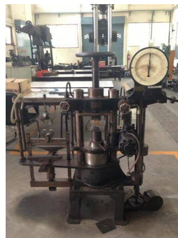
ภาพที่ 3.7 เครื่องทดสอบกำลังรับแรงอัด
