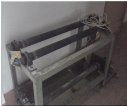
ภาพที่ 3.2 เครื่องบด (Tube mill)
