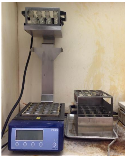
ภาพที่ ข.1 เครื่องย่อยไนโตรเจน (Kjeldahl Digestion Units)
