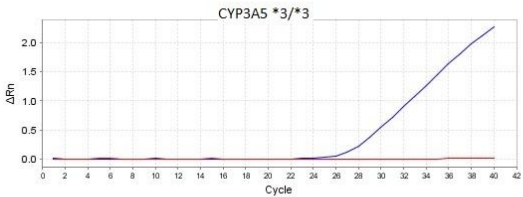
ภาพที่ 10 ตัวอย่างกราฟ amplification plot ที่แปรผลว่าเป็น CYP3A5*3/*3
