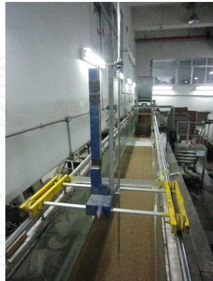
รูปที่ ก-5 เข็มวัดระดับ (point gauge)
