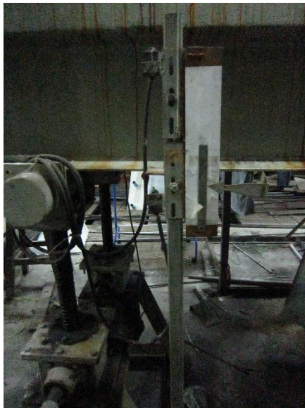
รูปที่ ก-4 สเกลวัดความลาดเอียงท้องน้ำ
