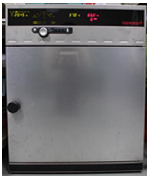
รูปที่ 17 แสดงตู้ควบคุมอุณหภูมิ
