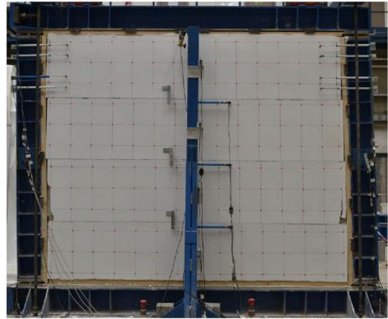
รูปที่ 2.15 ลักษณะรอยแตกของผนังที่ไม่มีช่องเปิดหลังจากรับแรงวิถุจักร 3 รอบ ที่ 2.5% drift
