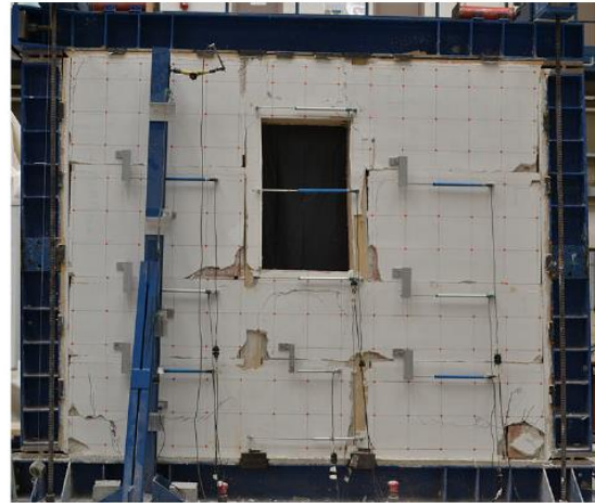
รูปที่ 2.16 ลักษณะรอยแตกของผนังที่มีช่องเปิดหลังจากรับแรงวิถุจักร 3 รอบ ที่ 2.5% drift
