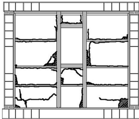
รูปที่ 2.16 ลักษณะรอยแตกของผนังที่มีช่องเปิดหลังจากรับแรงวิถุจักร 3 รอบ ที่ 2.5% drift
