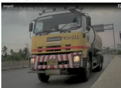
รูปที่ 3.20 ตัวอย่างรถบรรทุก 10 ล้อ 3 เพลลา ที่ใช้เป็นรถในการสอบเทียบ
