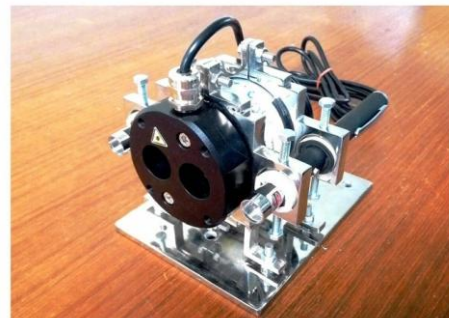
รูปที่ 3.15 ตัวยึดจับอุปกรณ์ระบบตรวจจับเพล่า Laser Rangefinder
