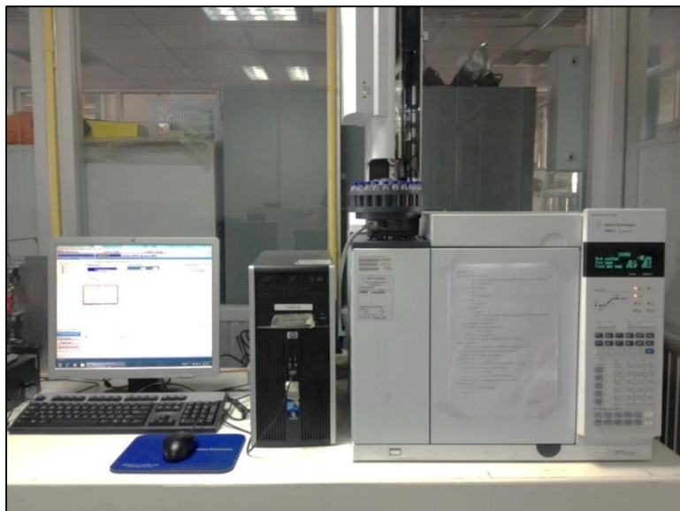
รูปที่ 3.4 เครื่องแก๊สโครมาโทกราฟีจำลองการกลั่น
