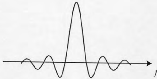
สเปกตรัมของการมอดูเลชันแบบคลื่นพาห์เดียว
