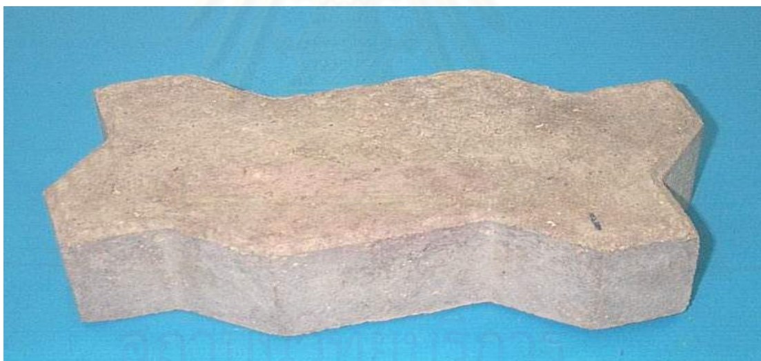
รูปที่ 2.9 คอนกรีตบล็อกประสานปูพื้นแบบคดกรีซ ซึ่งตะกรันดีบุกแทนที่ปูนซีเมนต์ปอร์ตแลนด์ร้อยละ 30 โดยน้ำหนัก
