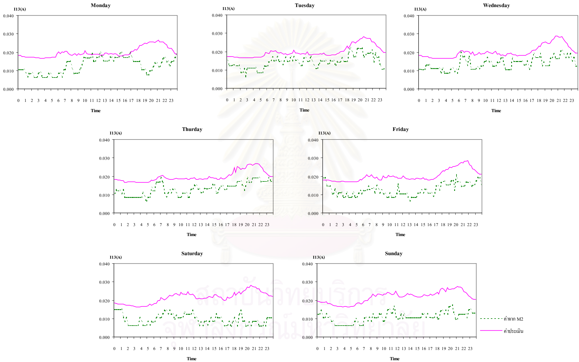
รูปที่ 5.14 กระแสฮาร์มอนิกเฉลี่ยลำดับที่ 13 จากสายป้อนของเครื่องมือวัด M2
