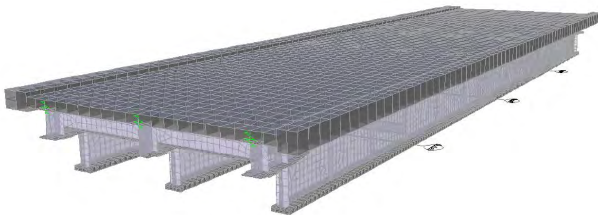
รูปที่ 6.26 แสดงแบบจำลองสะพานที่ได้ทำการติดตั้งแผ่นเหล็กหนา 10 มิลลิเมตร ใต้คานสะพาน
