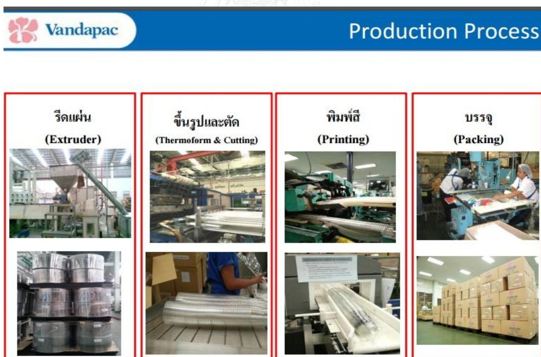
รูปที่ 2.3 ขั้นตอนการผลิตแก้ว Ingeo ของบริษัทแวนด้าแพค จำกัด
