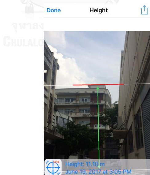
รูป 5.8 แสดงผลการวัดความสูงของจุดที่ต้องการวัดบนอาคารวิศวกรรมโยธาด้วยโปรแกรมประยุกต์
