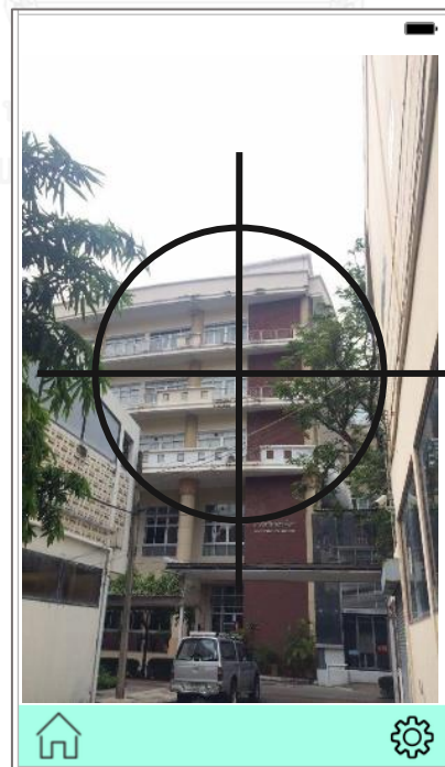
รูป 5.33 แสดงหน้าต่างรับค่ามุมตั้งของจุดสูงสุดของสิ่งที่ต้องการวัด
