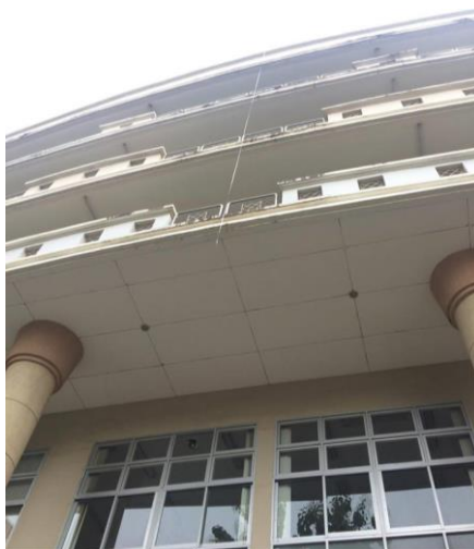
รูป 5.3 แสดงการวัดความสูงของจุดที่ต้องการวัดบนอาคารวิศวกรรมโยธาด้วยสายวัด
