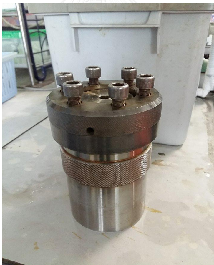
รูปที่ 3.4 ชุดอุปกรณ์โลหะสำหรับทำกระบวนการไฮโดรเทอร์มอล
