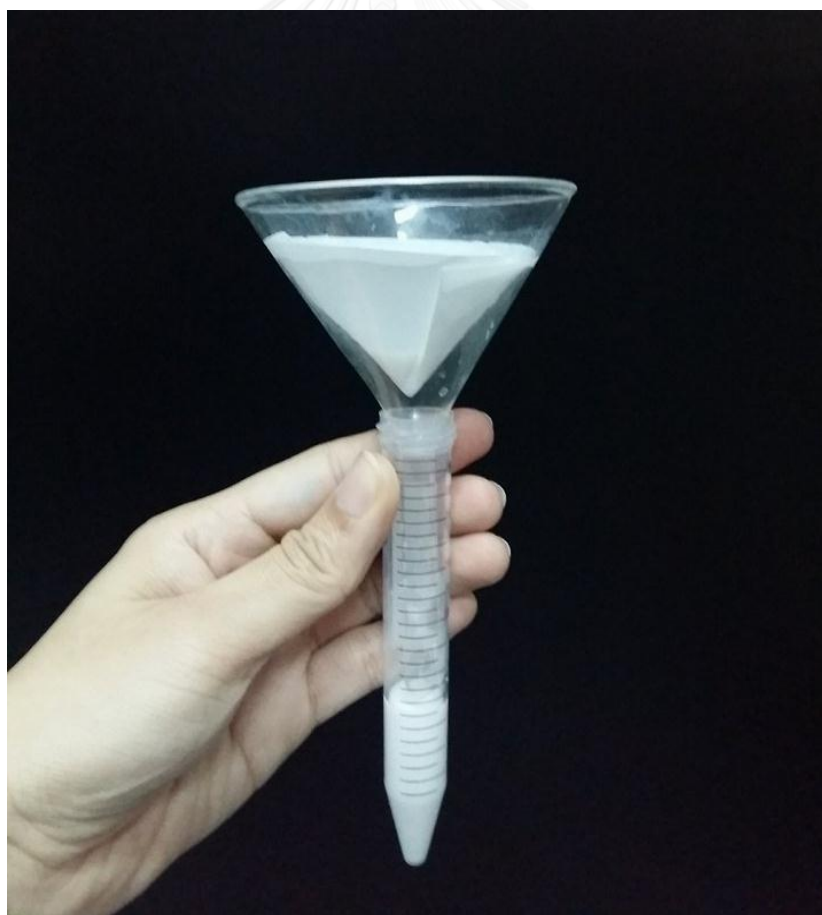
รูปที่ 3.1 รูปแบบการกรองสารไทเทเนียมไดออกไซด์
