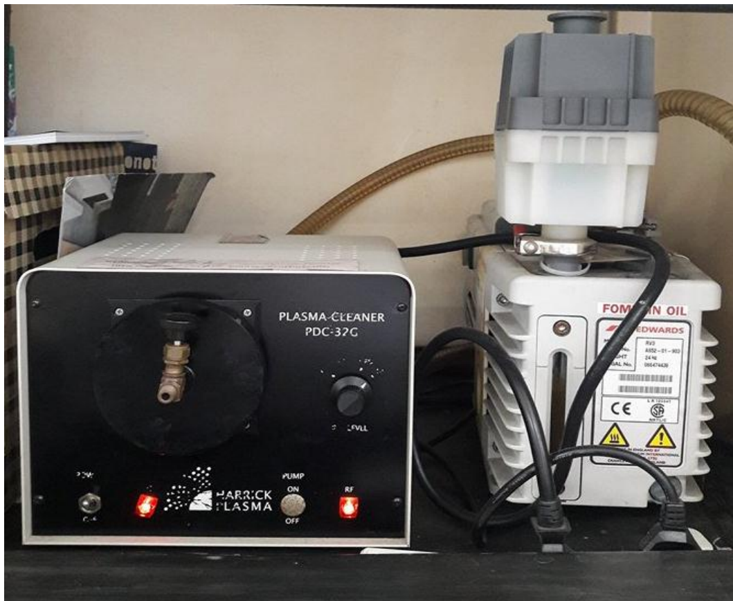
รูปที่ 5.1 อุปกรณ์สำหรับกระบวนการ oxygen plasma
