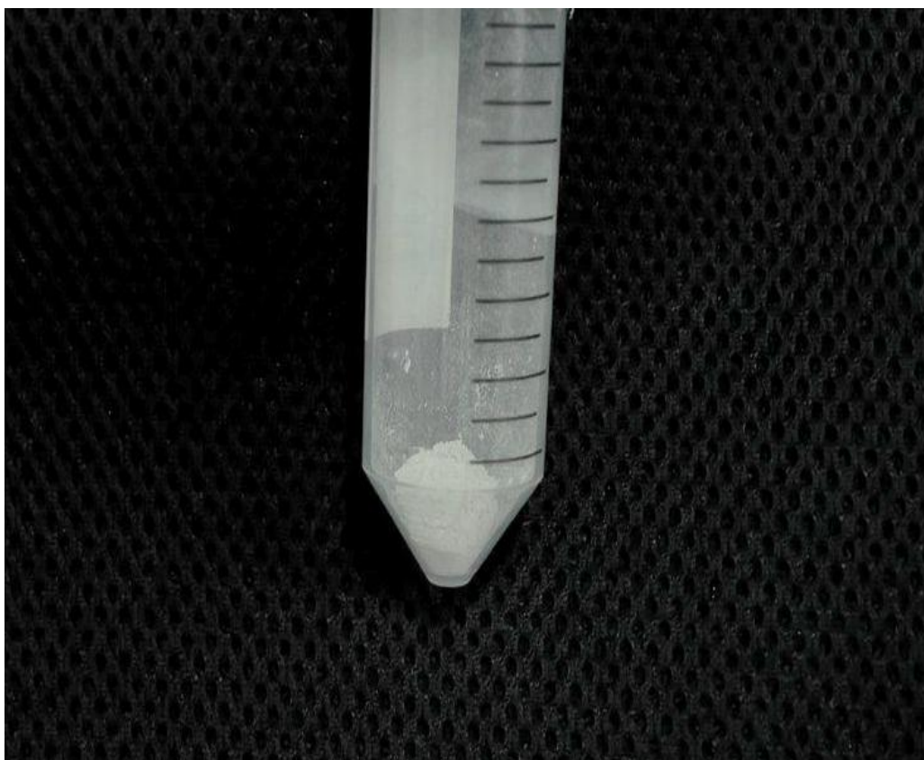
รูปที่ 3.5 ผงนาโนคอมโพสิตของไทเทเนียมไดออกไซด์-กราฟีนออกไซด์
