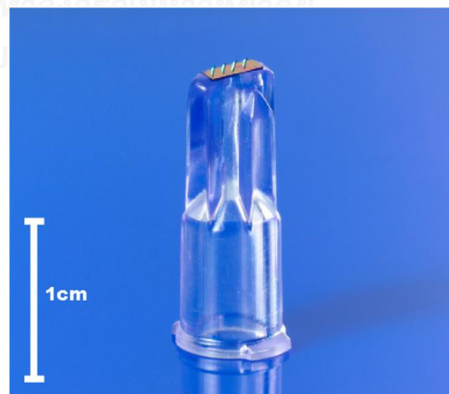
รูปที่ 2.12 อุปกรณ์การส่งยาแบบต่อเข้ากับกระบอกฉีดยาในงานของ P. Van Damme et al.[17] ที่ใช้กับกระบอกฉีดยาทั่วไป
