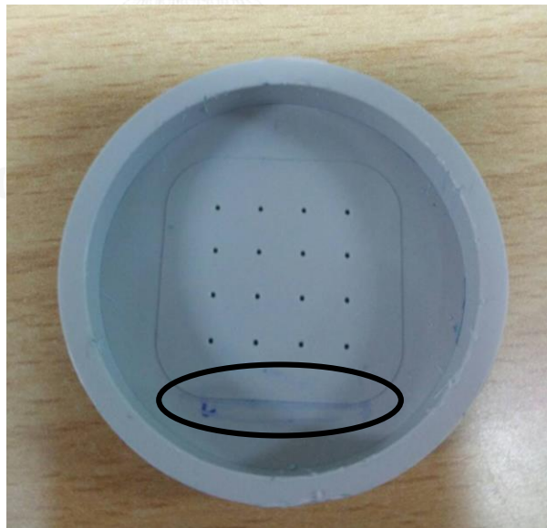
รูปที่ 6.5 แสดงอุปกรณ์การส่งยาส่วนซัสเตรตที่จุดที่ยารั้วออกมา
