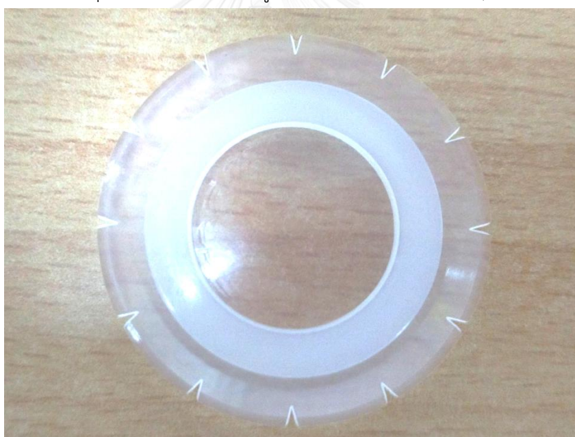
รูปที่ 4.4 แสดงส่วนส่งยาที่ได้จากการฉีดพลาสติก
