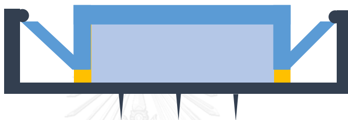
รูปที่ 5.3 แสดงแผนภาพตัดขวางของส่วนส่งที่ผ่านการปรับปรุงด้วยการเพิ่มวงแหวนส่วนล่าง(ส่วนสีเหลือง)
