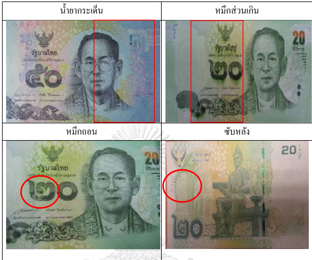
รูปที่ 1.19 ตัวอย่างของเสียชิ้นงานพิมพ์สีเส้นนูน
