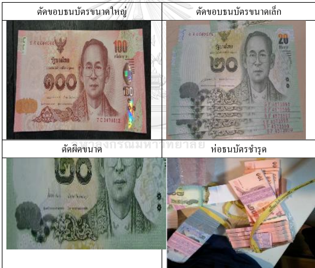
รูปที่ 1.21 ตัวอย่างของเสียชิ้นงานธนบัตรสำเร็จรูป
