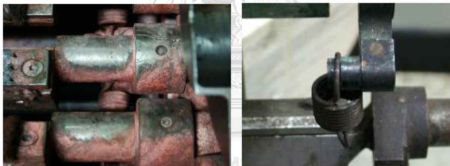
รูปที่ 4.5 สปริงยึดสก็อตไบต์ในอ่างน้ำยาลูกกลิ้งเซ็ดหมึก
