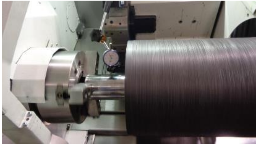
รูปที่ 4.8 วิธีตรวจสอบความกลม โดยใช้นาฬิกาวัด
