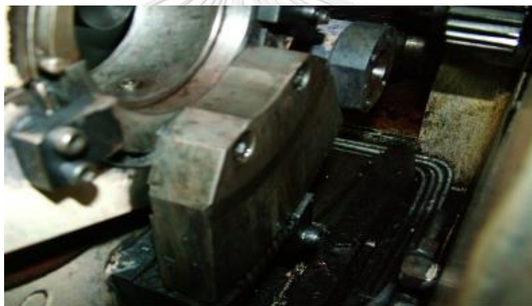
รูปที่ 3.10 ชุดประกอบของลูกกลิ้งเช็ดหมึก
