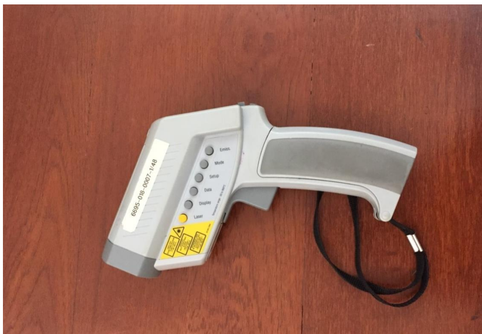
ภาพที่ 12 อุปกรณ์ Laser Gun ใช้ในการเก็บข้อมูลอุณหภูมิอากาศและความชื้นสัมพัทธ์ ภายในอาคาร
