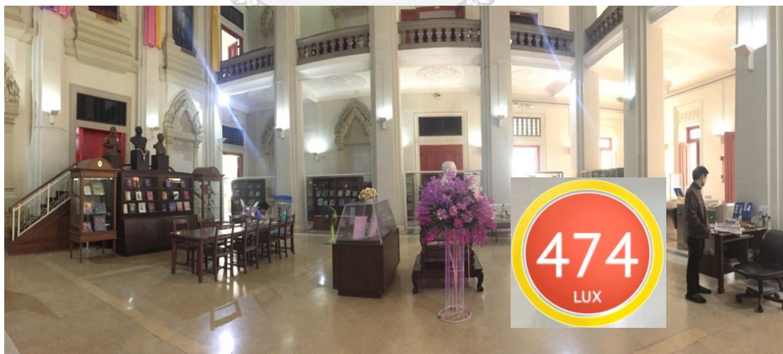
ภาพที่ 93 ความสว่างโถงห้องสมุด หลังการปรับปรุงมีค่า 474 ลักซ์ ตรงบริเวณพื้นที่นั่งอ่าน หนังสือ เมื่อวันที่ 22 มกราคม 2559
