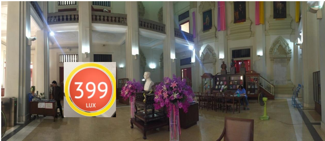
ภาพที่ 92 ความสว่างโถงห้องสมุด หลังการปรับปรุงมีค่า 399 ลักซ์ ตรงบริเวณทางเข้าโถง เมื่อวันที่ 22มกราคม 2559
