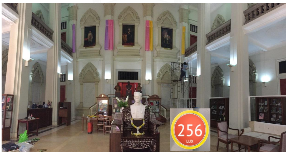
ภาพที่ 91 ความสว่างโถงห้องสมุด ก่อนการปรับปรุงมีค่า 256 ลักซ์ ตรงบริเวณโต๊ะใกล้กับทางเข้าโถง เมื่อวันที่ 12 พฤศจิกายน 2558
