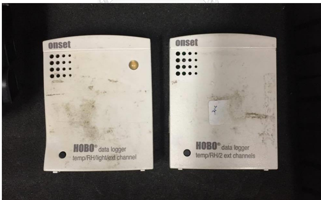
ภาพที่ 11 อุปกรณ์ Data Logger ใช้ในการเก็บข้อมูลอุณหภูมิอากาศและความชื้นสัมพัทธ์ภายในอาคาร
