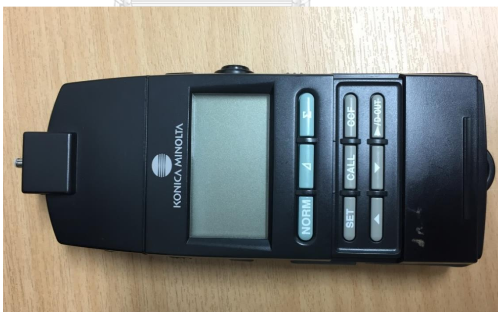
ภาพที่ 13 อุปกรณ์ Lux meter ใช้ในการวัดค่าแสงสว่างภายในและภายนอกอาคาร
