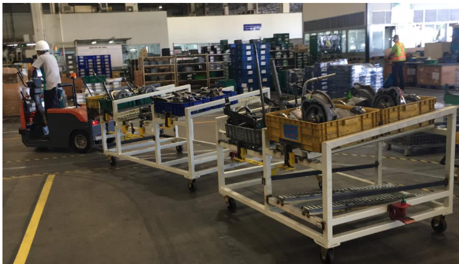
รูปที่ 4.13 การใช้ระบบรถมิลค์รันสำหรับขนส่งชิ้นส่วน
