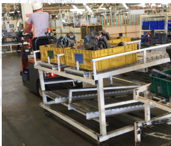
รูปที่ 3.9 การขนส่งภาชนะบรรจุชิ้นส่วนไปยังจุดส่งที่สายการประกอบหลัก
