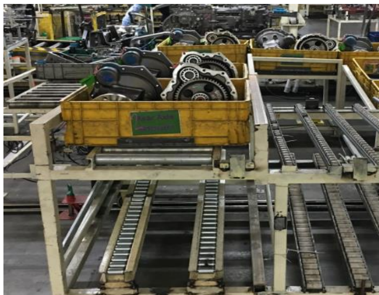
รูปที่ 4.19 จูร์รับชิ้นส่วนอัตโนมัติชิ้นส่วนเพลาล้อหลัง
