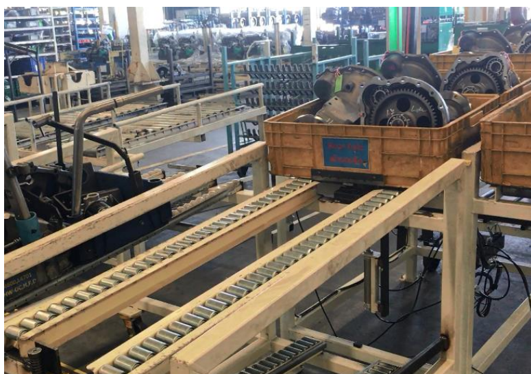
รูปที่ 4.17 จุดรับชิ้นส่วนอัตโนมัติชิ้นส่วนเพลาล้อหลัง
