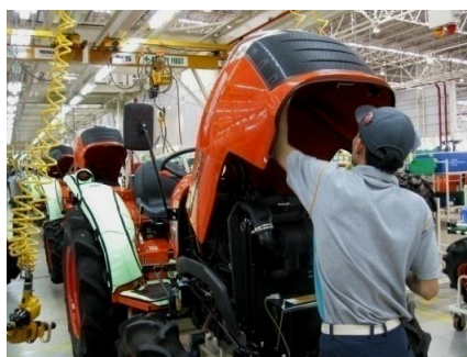
รูปที่ 1.13 ขั้นตอนการประกอบชิ้นส่วนภายนอกขั้นสุดท้าย
