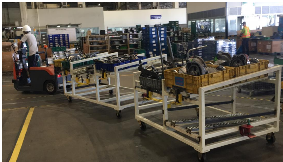
รูปที่ 5.2 ระบบขนส่งชิ้นส่วนด้วยรถมิลค์รัน
