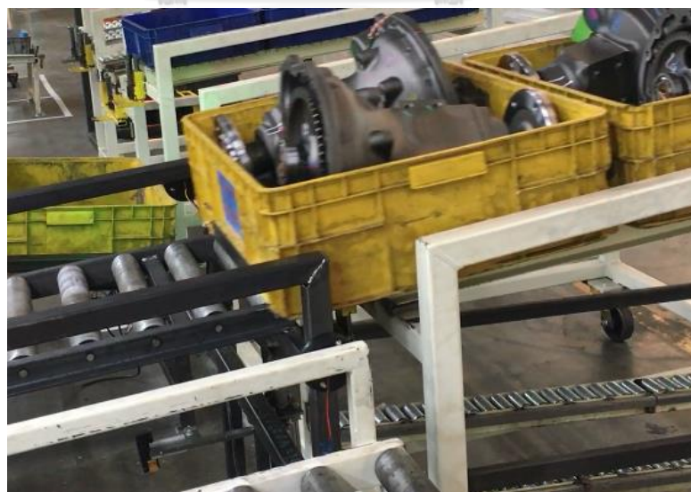
รูปที่ 4.18 จุดส่งชิ้นส่วนอัตโนมัติชิ้นส่วนเพลาล้อหลัง
