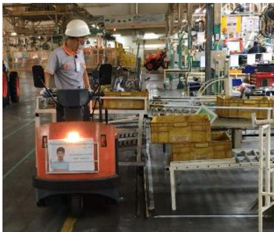
รูปที่ 3.10 การโหลดภาชนะบรรจุชิ้นส่วนจากรถขนส่งลงจุดส่งที่สายการประกอบหลัก
