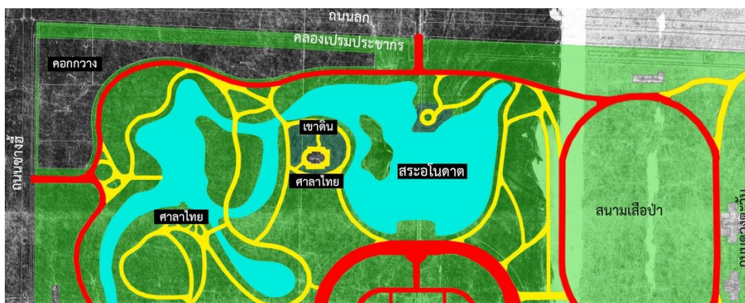
ภาพที่ 16 ผังเขาดินวนาที่ 4 แสดงเส้นทางสัญจรหลัก เส้นทางสัญจรรอง และการนำน้ำเข้ามาใช้ในพื้นที่
