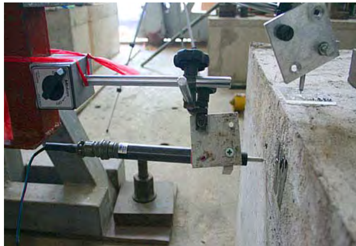
รูปที่ 4.22 การติดตั้งเครื่องวัดการเคลื่อนที่แบบไฟฟ้าที่ใช้วัดการเคลื่อนที่ของฐานราก
