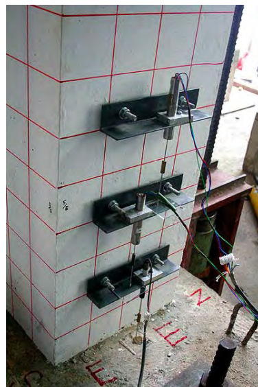
รูปที่ 4.20 การติดตั้งเครื่องวัดการเคลื่อนที่แบบไฟฟ้าที่ใช้วัดการหมุนที่โคนเสา
