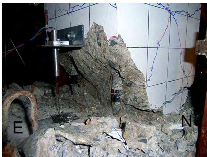
รูปที่ 5.2 ลักษณะของตัวอย่าง C-12-150 หลังสิ้นสุดการทดสอบ
