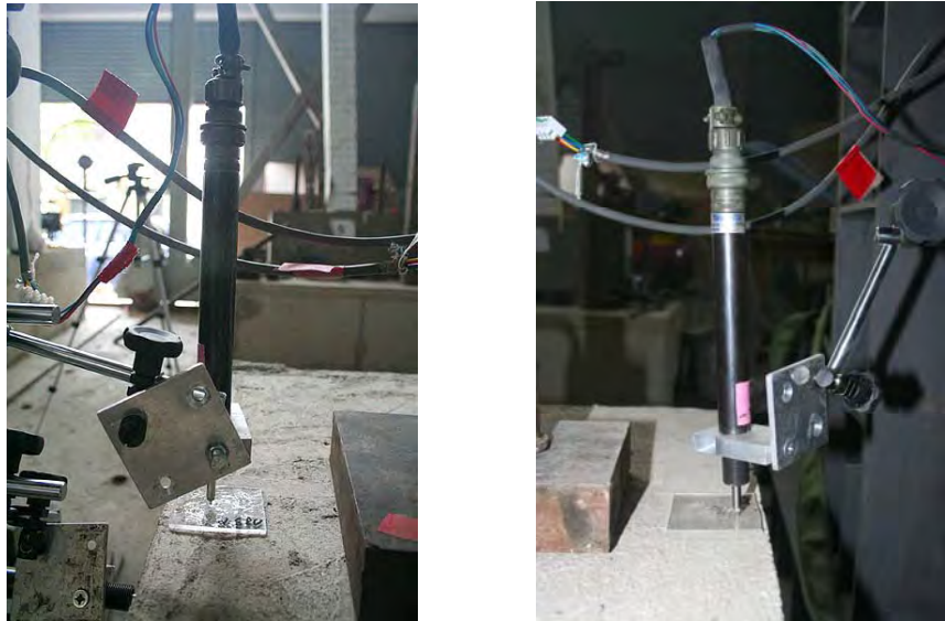
รูปที่ 4.21 การติดตั้งเครื่องวัดการเคลื่อนที่แบบไฟฟ้าที่ใช้วัดการหมุนของฐานราก
