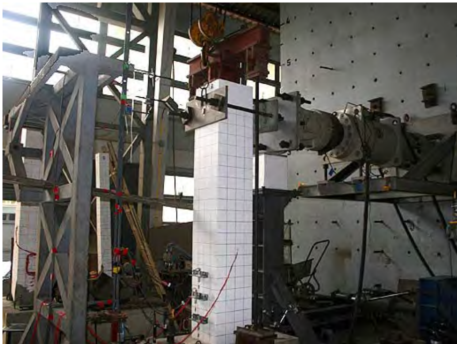
รูปที่ 4.17 การติดตั้งตัวอย่างทดสอบ
