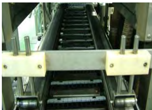
รูปที่ 3.16 แสดงการลำเลียงเฟรมงานเข้าตู้อบ
