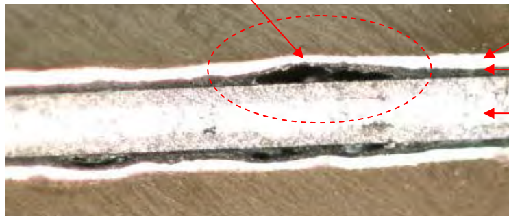
รูปที่ ก1 ภาพตัดขวางภายในชิ้นงานเสียค่ากระแสไฟฟ้ารั่วไหล
