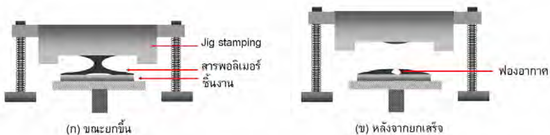
รูปที่ 5.9 แสดงลักษณะการเกิดฟองอากาศบนผิวชิ้นงาน
