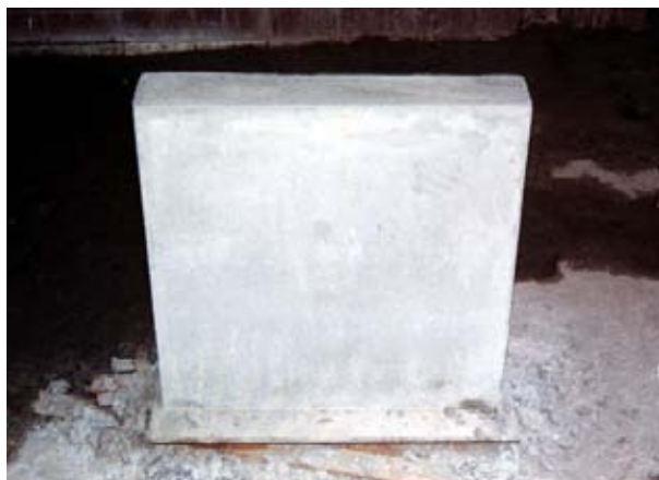
ภาพที่ 3.14 ผนังก่ออิฐ 1 ชั้นที่ใช้ในการทดลอง
