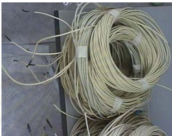
ภาพที่ 3.3 Sensor วัดอุณหภูมิชนิด Thermister 10\text{ k}\Omega
