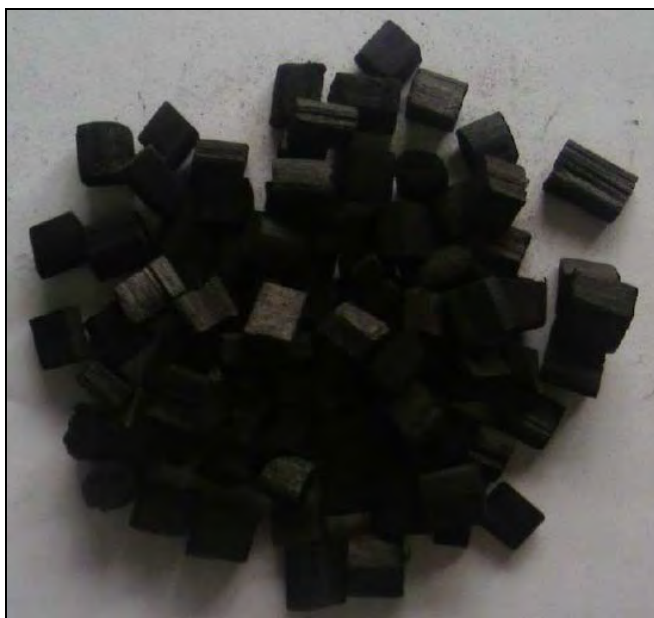
รูปที่ 4.1 ลักษณะของถ่านไม้ยูคาลิปตัสจากการเผาที่อุณหภูมิ 450 องศาเซลเซียส ที่เวลา 30 นาที
